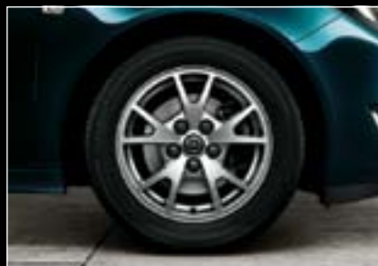
Obręcze kół ze stopów lekkich 16 x 6,5" 5-ramienne w układzie V, opony 215/60 R 16 (RRZ) 1
