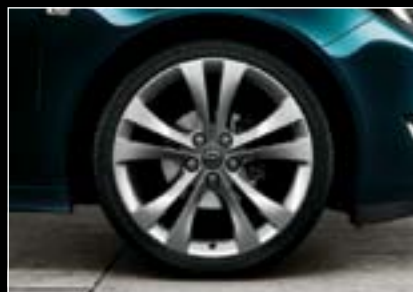
Obręcze kół ze stopów lekkich 20 x 8,5" 5-ramienne podwójne, polakierowane wielowarstwowo, opony 245/35 R 20 (RTH) 1
