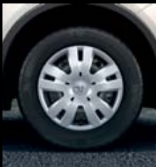
Stalowe obręcze kół 16 x 6,5" opony 205/70 R 16 (RRY). Wyposażenie standardowe wersji Active.
