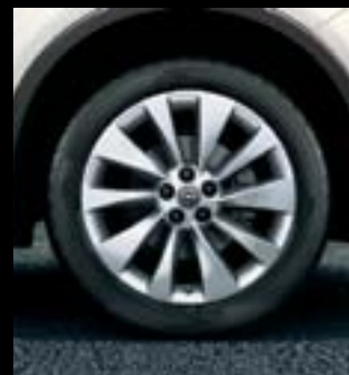
Obręcze kół ze stopów lekkich 18 x 7" wieloramienne, opony 215/55 R 18 (RV8). Wyposażenie standardowe wersji Cosmo.
