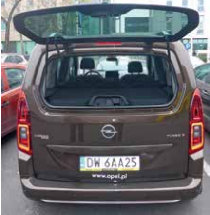
Szyba w tylnych drzwiach jest na siłownikach i można ją otworzyć.
