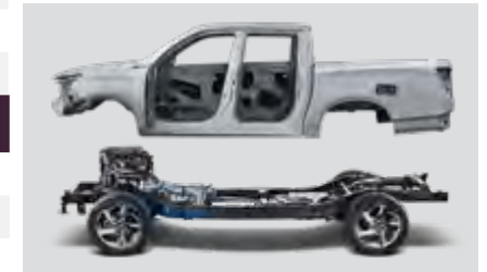
Nadwozie i rama ze stali o bardzo wysokiej wytrzymałości na rozciąganie
