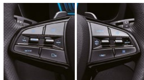
Przełączniki radia oraz tempomatu na kole kierownicy
